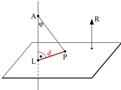
Weg 4: Das Dreieck LPA ist rechtwinklig. Mit  $\sin \varphi = \frac{d}{|A - P|}$  gilt für das Kreuzprodukt  $|(A - P) \times R| = |A - P| \cdot \sin \varphi = d$  und deshalb mit  $D = A - P$  schließlich  $d = |D \times R|$ .
