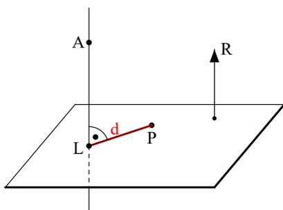
Weg 1: Die zu  $g$  senkrechte Ebene durch  $P$  hat die Gleichung  $X \cdot R = P \cdot R$ ; sie schneidet  $g: X = A + \lambda \cdot R$  für  $\lambda = (P - A) \cdot R$  im Lotfußpunkt  $L = A + ((P - A) \cdot R) \cdot R$ , woraus mit  $D := A - P$  schließlich  $d = |L - P| = |D - (D \cdot R) \cdot R|$  folgt.
